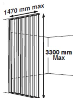
La lisse et les barreaux sont à recouper sur chantier. La chute des barreaux les plus longs va être réutilisée pour faire les barreaux les plus courts.
