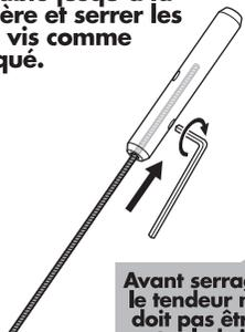
Avant serrage le tendeur ne doit pas être contre la bride
