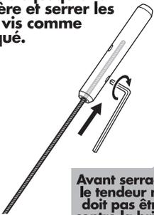
Avant serrage le tendeur ne doit pas être contre la bride
