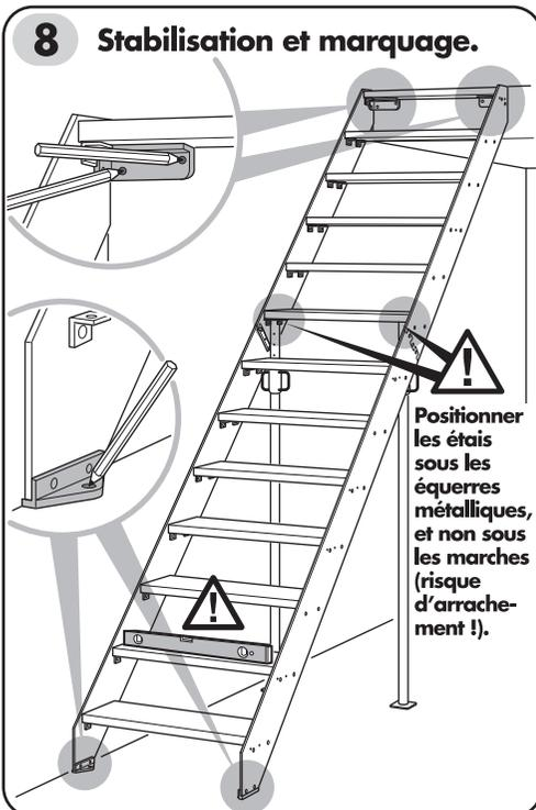
Positionner les étais sous les équerres métalliques, et non sous les marches (risque d'arrachement !).
