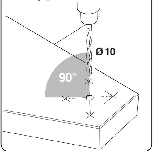
**18** Fixation des poteaux - 4 - Perçage du nez de marche et fixation.
