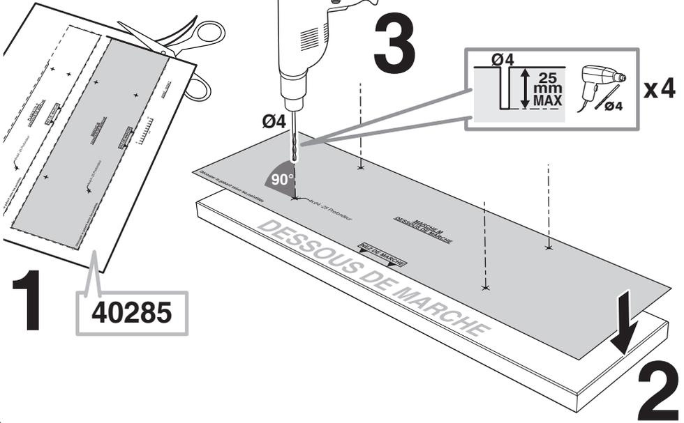
**2** Perçage de la plaquette P - méthode recommandée (avec gabarit fourni).
