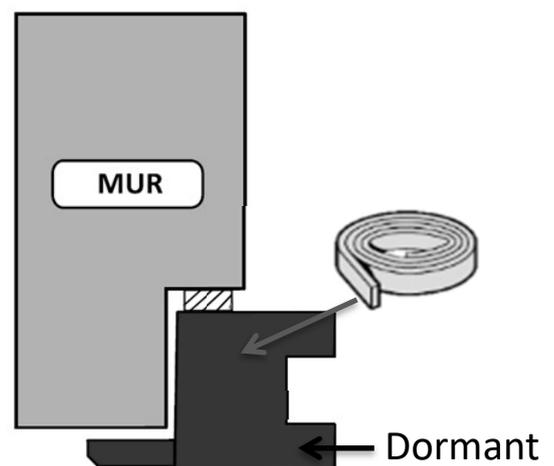
Pour un **fond de joint** : l'insérer entre la maçonnerie et la menuiserie une fois fixée.
