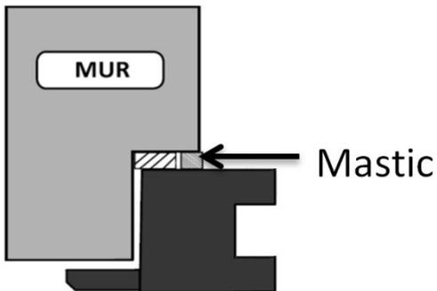
Appliquez un joint de finition au mastic entre la menuiserie et la maçonnerie.
