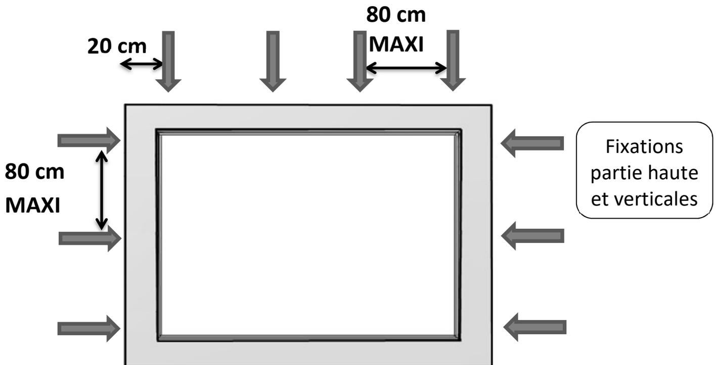
Coffre à volet roulant : les fixations seront doublées au niveau de la traverse haute.
