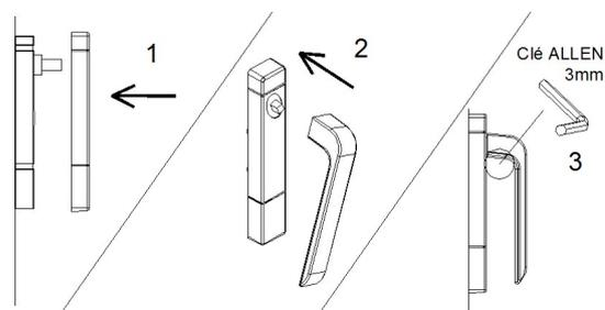
Remettez le capot sur l'embase (1), remettez la béquille sur le carré (2) et verrouillez la béquille en serrant la vis sans la béquille (3).
