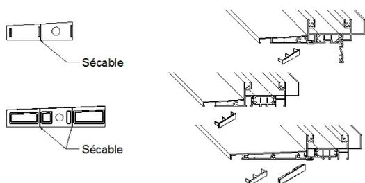
Posez les bouchons fournis en colis sur les extrémités de la pièce d'appui.
