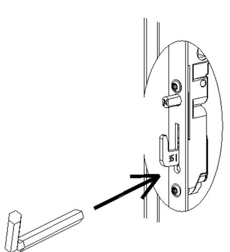
Serrez et/ou desserrez la vis de réglage sous le crochet central de la crémore pour diminuer ou augmenter le jeu en profondeur du crochet.
