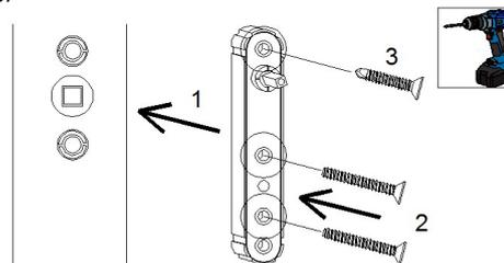
Mettez l'embase sur le montant (1), mettez les vis par les logements en face des écrous cage (2) et vissez à l'aide d'une visseuse la vis auto-foreuse par le logement supérieur (3).
