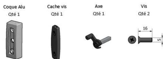
Insérez l'axe dans le boîtier crémonne (perçage central) en position ouvert, positionnez la coque alu et vissez les 2 vis dans les inserts prévus. Clippez le cache vis en mettant les cadenas en bonne position.
