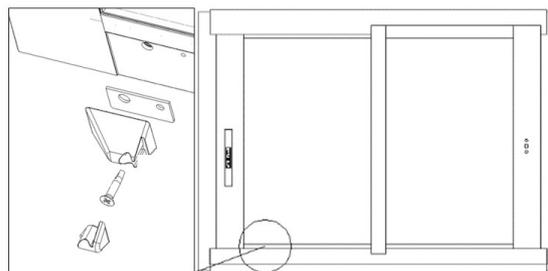
Placez la butée d'ouvrant avec sa cale dans son logement sur la traverse ouvrant et mettez la vis. Emboîtez la partie caoutchouc pour cacher la tête de vis.
