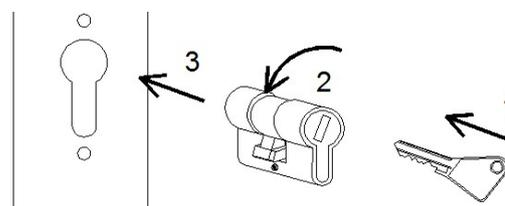
Insérer la clé dans le barillet (1) puis tournez la clé (2) de manière à pouvoir insérer le barillet dans le trou de serrure.
