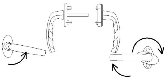
Mettez les deux béquilles en position ouverte et tournez le capot pour faire apparaître l'emplacement des vis.
