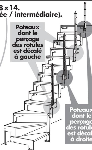
Poteaux dont le perçage des rotules est décalé à droite
