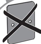
(pas de cale sur les équerres extérieures et utilisation des vis M8x20)
