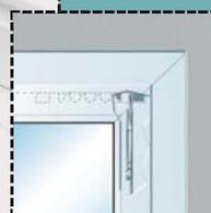
Position fermée. La gâche d'entrebâillement permet d'avoir un point de verrouillage supplémentaire
